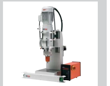
32 Smartline und Ecoline Die Radial- und Taumelnietmaschinen in reduzierter Ausführung zu einem attraktiven Preis in bekannter Baltec Qualität. Zur Vernietung von Niete Ø 1 mm bis Ø 12 mm, Kräfte bis 17 kN.
