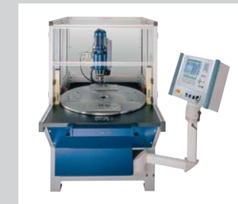
31 CNC High Speed Koordinaten Nietmaschine Optimale Visualisierung mit Touch Panel, schnelle und einfache Programmierung, flexibel und hohe Verfügbarkeit.
