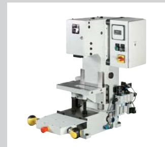
22 Pneumatische Kniehebelpressen KH Von 20 kN bis 100 kN, vergrößerte Einbauhöhe möglich, sehr präzise und spielfrei einstellbare Prismenführung. Pressensteuerung elektrisch, Baumuster geprüft mit 2 Handauslösung.
