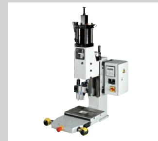
21 Linearwirkende Pneumatikpressen LP Von 4 kN bis 56 kN, vergrößerte Einbauhöhe und Ausladungsvergrößerung möglich. Sehr präzise und spielfrei einstellbare Prismenführung. Pressensteuerung elektrisch, Baumuster geprüft mit 2 Handauslösung.
