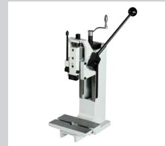
18 Zahnstangenpressen HZP 2 kN und 4 kN, vergrößerte Einbauhöhe und Ausladungsvergrößerung möglich.
