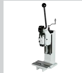
19 Handkniehebelpressen HKP Von 2,5 kN bis 50 kN, vergrößerte Einbauhöhe und Ausladungsvergrößerung möglich. Sehr präzise und spielfrei einstellbare Prismenführung.
