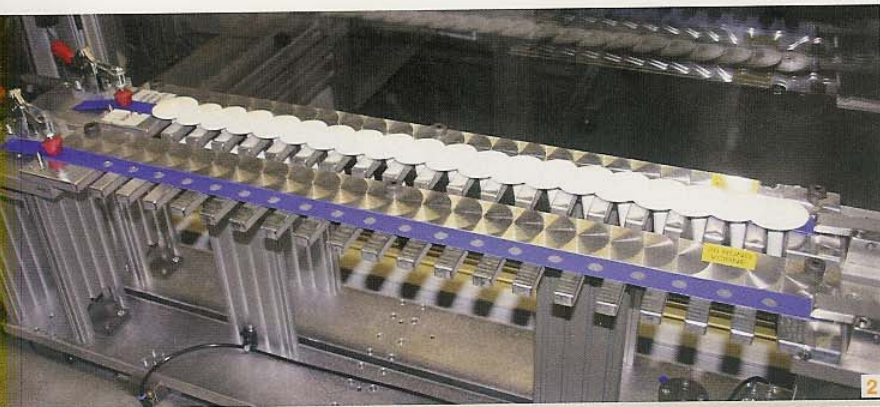
1 Frontansicht der Montagezelle für die Kunststoff-Schraubkombinationen: Rechts ist der Rüstplatz für manuelles Handling mit den Magazingurtbändern zu sehen.
