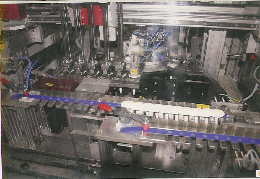
3 Bestückungsbereich für die Magazingurtbänder: Oben ist das elektrische Portalmodul mit 820 mm Hub zu sehen – und daran ist die Fünf- bzw. Vierfach-Einheit zum Einsetzen der Kunststoff-Schraubkombinationen installiert. Unten ist das Portalmodul mit 400 mm Hub zum flexiblen Verfahren in die jeweilige Bestückungsposition zu sehen.
